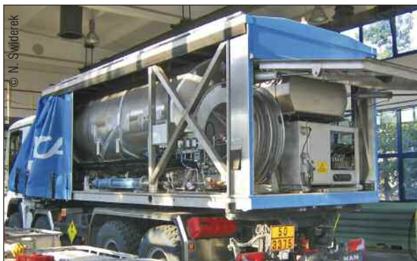
Najnowszy pojazd wykonany dla Oriki – zbiorniki i urządzenia mieszające zabudowane jako kontener
