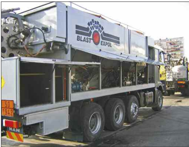
UMS 2000 – w specjalnych zbiornikach przewożone są składniki do produkcji wielu rodzajów materiałów wybuchowych
